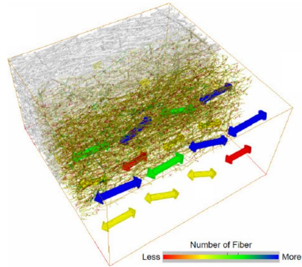
그림에서는 처리의 과정을 이해 하기 쉽게 볼륨 데이터를 4 층으로 나누어 표현하고 있습니다. 안쪽부터 바깥쪽으로 1, 2, 3, 4 층으로 보아 안쪽의 1 층은 오리지날의 CT 화상을 반투명으로 한 상태, 바깥쪽의 4 층은 섬유의 배향성을 나타내는 벡터 표시, 2 층은 Medial Axis 와 1 층을 합쳐 본 상태, 3 층은 Medial Axis 와 4 층을 합쳐 본 상태를 표시하고 있습니다. 벡터는 볼륨 데이터 전체를 4 × 4 × 2 의 직방체의 메시에 분할해 각각의 영역내에서 검출된 Medial Axis 전부의 관성 모멘트를 계산해 평균화한 것으로 섬유의 평균적인 배향 방향을 나타냅니다. 라인보우 칼라는 검출된 섬유의 양을 나타내고 있습니다. 빨강색으로 갈 수록 섬유의 수가 작아지고 반대로 갈 수록 많아짐.
