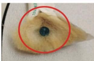
メンソールカプセル入りタバコのフィルタ部をX線CT装置で撮像。
